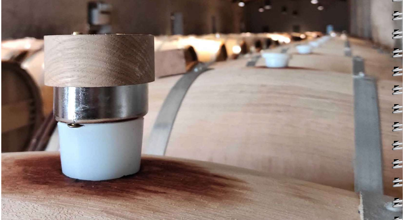
Sonde de mesure de paramètres Onafis le chai connecté. © My Bacchus
